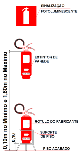
Figura 3: DETALHE DE FIXAÇÃO E SINALIZAÇÃO DO EXTINTOR
